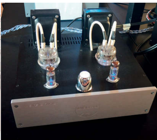
MARZIANINO è il nome che Federico Carioligi ha dato al suo amplificatore, ispirato dall'aspetto della valvola finale, una 832 con catodo comune di provenienza russa: il progetto prende spunto da una realizzazione di Audio Hobbyst, rivista e modificata con 12BH7A come stadio di ingresso. L'amplificatore si presenta molto compatto ed eroga 6 watt, con distorsione massima, prima del clipping, del 10%: le uscite di potenza possono essere selezionate a 4 oppure 8 ohm e l'apparato può essere utilizzato come finale, bypassando il controllo del volume.
