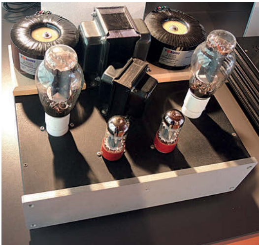
L'amplificatore valvolare TRIODINO è una realizzazione di Luca Mattolini del famoso amplificatore valvolare single-ended equipaggiato con valvola 300B. Prototipo in continua evoluzione, prende spunto dal classico "Triodino 3" ed è usato come base per sperimentazioni circuitali: in questa ultima versione, equipaggiato con trasformatori di uscita toroidali Toroidy, eroga 8 watt con una distorsione massima del 5%.
