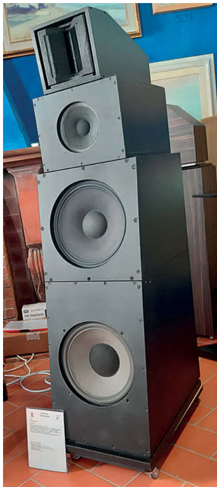
L'imponente "Woodstock" di Fabio Falcinelli è un sistema a quattro vie da pavimento equipaggiato con woofer ESS da 30 cm, medio-basso Ciare da 30 cm, medio Audax da 17 cm e tweeter ESS AMT. Ogni diffusore è composto da quattro moduli con caricamento a dipolo, escluso il woofer, che una volta montati portano l'altezza a circa 130 cm. Gli altoparlanti incrociano a 250 Hz, 1.000 Hz e 3.600 Hz; la sensibilità è pari a 92 dB/W/m; la potenza a 150 W.
