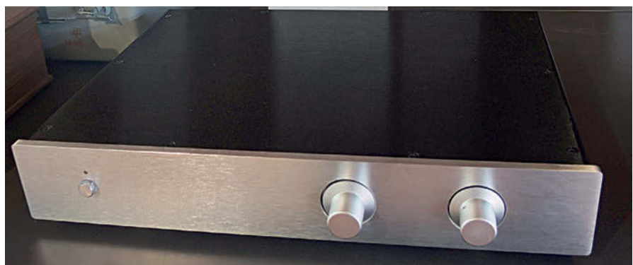
Definito NACchero 50.1, il preamplificatore a stato solido realizzato da Marco Franchi è basato su schema NAIM, riveduto e parzialmente corretto o modificato. La costruzione ha visto anche la realizzazione del circuito stampato per alloggiare gli stadi di segnale ed alimentazione e particolare cura è stata posta nella selezione dei componenti, attivi e passivi.
