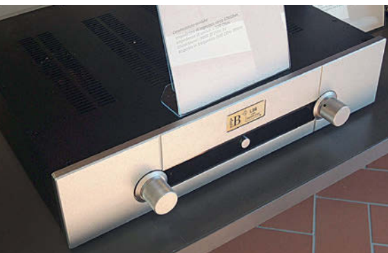
L'SL6 presentato da Davide Bucciarelli è un preamplificatore di linea ibrido valvole transistor, dai circuiti inusuali. Lo stadio di ingresso è formato da un differenziale basato su triodi 2C51, specifici per impiego audio, polarizzato con un pozzo di corrente impiegante un mosfet DN2540: l'uscita utilizza un transistor video BF471 configurato ad emitter-follower mentre la selezione degli ingressi e la regolazione del volume, a scala resistiva, prevede dei micro-relè comandati da una logica a microprocessore.
