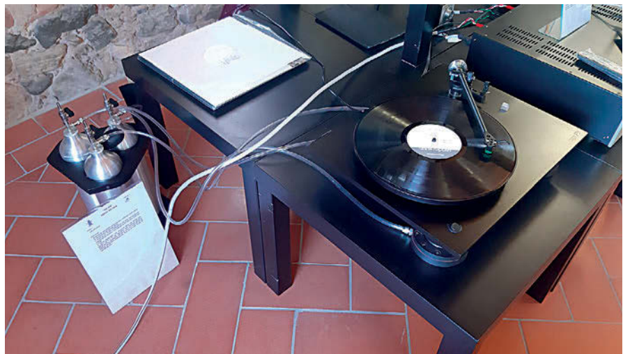
Notevole il sistema di isolamento vibro-acustico realizzato da Luca Ferretti, ispirato al Sistema Moss e basato su tre molle indipendenti ad aria con serbatoio pressurizzato esterno, con frequenza di risonanza inferiore a 3 Hz. Il carico applicabile per ciascuna delle molle può variare da 5 a 15 kg ed il sistema può isolare apparati fino ad un peso totale di circa 50 kg, essendo quindi adatto anche ai diffusori. L'isolamento a frequenza subsonica è stato dimostrato applicando le molle sotto ad un giradischi Rega, con udibile miglioria all'ascolto. Di alto livello la realizzazione meccanica.
